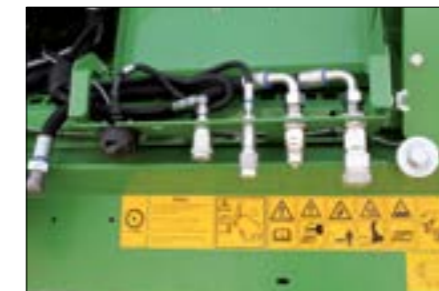
Ilman työkaluja Hydrauliikan liitäntöjen pikakiinnitys
